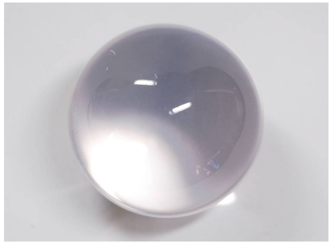
Fig 6 Die gleiche Kugel unter fast diffusem Licht. Der Sterneffekt tritt am deutlichsten bei einer punktförmigen Lichtquelle auf.
